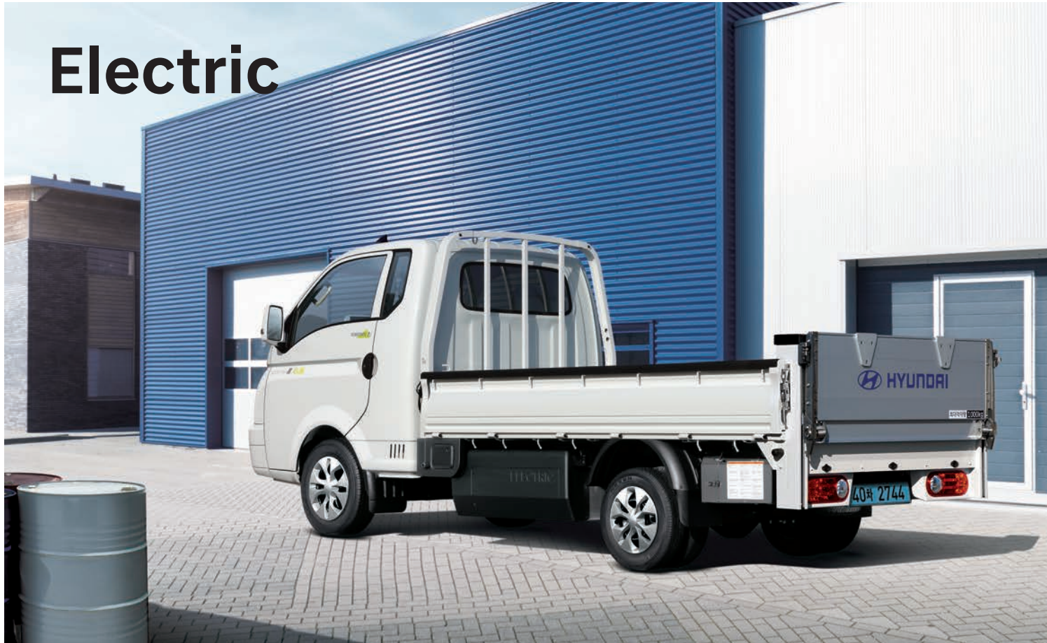
전동유압식 리프트 시스템 (허용하중 : 600kg)
